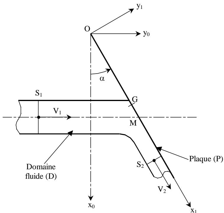
On considère une plaque carrée ( $P$ ) de côté  $a$ , de masse  $m$ . Cette plaque est mobile en rotation autour de l'axe  $Oz_0$ . Elle reçoit un faisceau liquide cylindrique de section  $S_1$ , d'axe horizontal,
